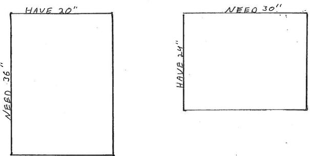
SECOND FLOOR WINDOWS REQUIRE MINIMUM 5.7 SQ. FT. FOR EGRESS.NET CLEAR OPENINGS SHALL BE AS SHOWN BELOW.
